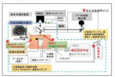
ーは、金ミラー(背景輻射)、疑似黒体(黒体輻射)、製品サンプルを1つのホルダーに取り付けてスライドさせ、気密容器を開閉せずに3つの放射を測定し、補正することで、製品サンプルの放射率を精度良く測定する新手法です。これらの改良により、繰り返し測定時のばらつきが抑えられることを確認しました。また、実際に製品サンプルの測定も行い、測定可能であることを確認しました。
